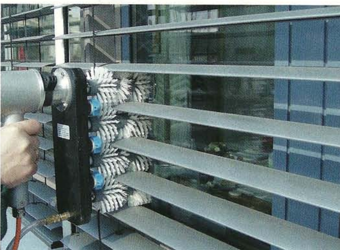
Einfache und professionelle Reinigung durch das mobile Bürsten-Walzen-System: Bürstenwalzen reinigen Lamellen und Zugbänder effektiv und materialschonend.
